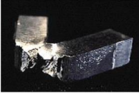
Şekil 2. Gevrek veya sünek kırılma sonucu numune görüntüleri
